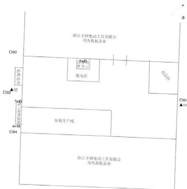
注: ▲: 噪声检测点位; ○: 固定污染源采样点
