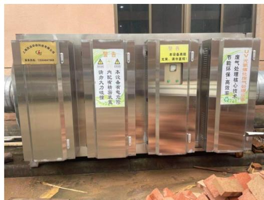
注塑废气处理装置
